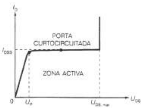
Fig. 10: Caraterística de dreno com a junção porta-fonte curto-circuitada
