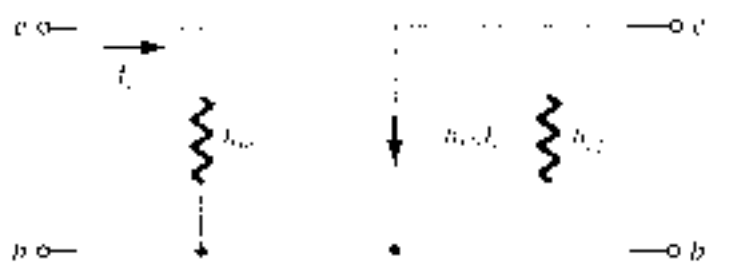
Fig. 36: Circuito híbrido equivalente aproximado para base-comum
